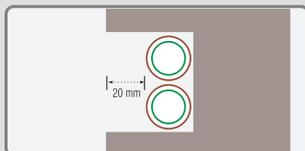
En tabiques anchos, las tuberías pueden ser inmobilizadas con un recubrimiento de mortero de 20 mm de espesor. Cuando esto es posible, la mezcla de cierre podrá ser cementicia.
