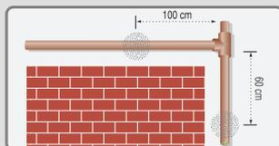
Para facilitar su empotramiento dentro de las canaletas, se sugiere puntear la instalación con una cucharada de mezcla de fraguado rápido cada metro de tendido, vertical u horizontal.
