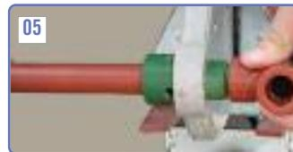
Introducir simultáneamente tubo y conexión, en sus respectivas boquillas, sin rotar ni torcer y ejerciendo una ligera presión.
