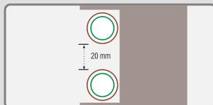
En tabiques delgados, la altura de la canaleta deberá ser lo suficientemente alta, como para admitir una luz de 20 mm entre la tubería de agua fría y caliente. La canaleta deberá cerrarse con un mortero fuerte.
