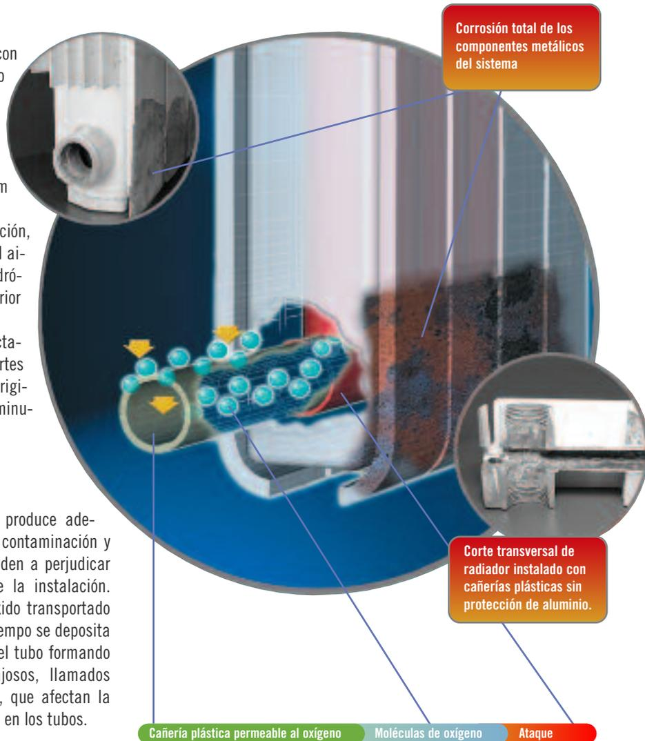
Cuando la temperatura sobrepasa los 40°C el efecto de difusión de oxígeno crece exponencialmente. Este fenómeno limita la utilidad de las tuberías plásticas en la conexión de radiadores. En un sistema de calefacción por radiadores la temperatura de servicio habitualmente supera los 70 u 80°C determinando valores de difusión de oxígeno muy elevados que propician la corrosión de los radiadores de aluminio.
